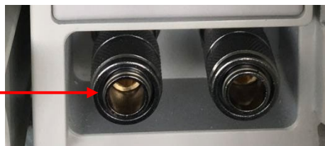
Vypouštěcí otvor odpadní voda
