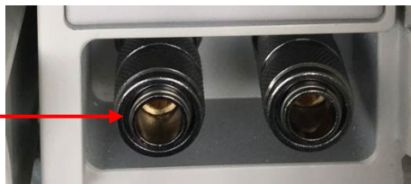
Odtočna vrata odpadna voda
