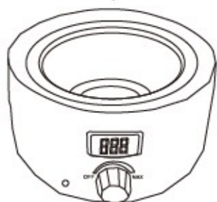
Control electronic al temperaturii cu termostat și indicator luminos
