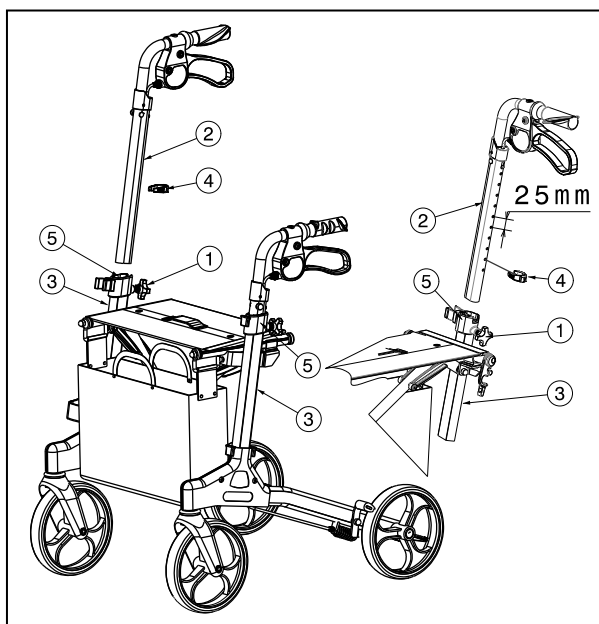
Fig. 2 – Regolazione delle maniglie di spinta
